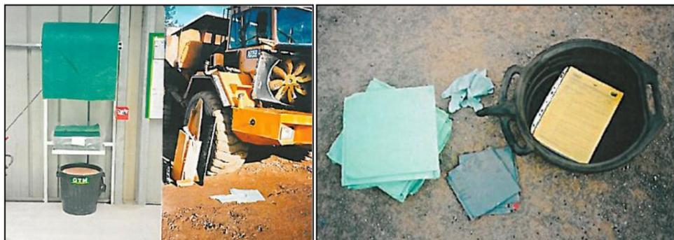
Figure 112 - Produits absorbants, kit antipollution pour l'entretien d'engins sur chantier
